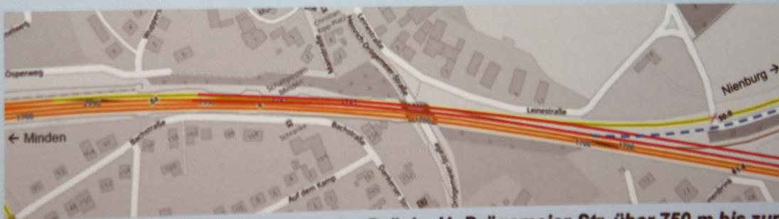
Die Personenbahn (unten) wird ab der Brücke H.-Drögemeler-Str. über 750 m bis zur Brücke B 482 abgesenkt und kann die Bestandsstrecke dann auf die Nordseite kreuzen.
